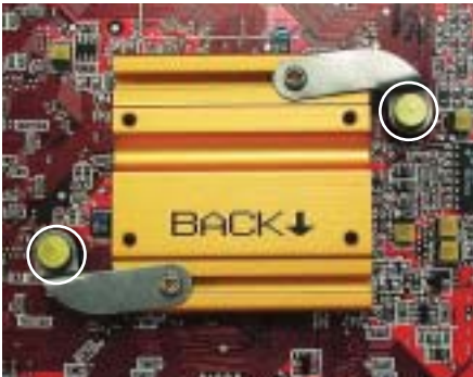
Rögzítsük a hátsó hűtőblokkokat a csavarokat lezáró sapkákkal (a képen fehéren bekarikázva láthatóak)
