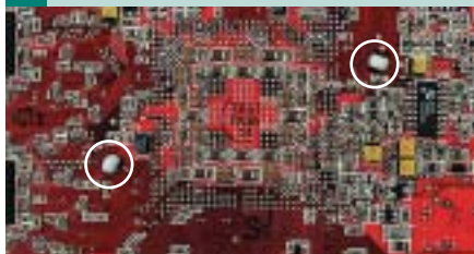
A két, fehér körrel bekarikázott műanyag büttyök tartja a hűtőventilátort a kártyán
