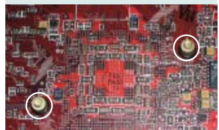
A fehérrel bekarikázott – a csavarok és a kártya lapja között található – gumigyűrűk nélkül rövidzárlat keletkezhet
