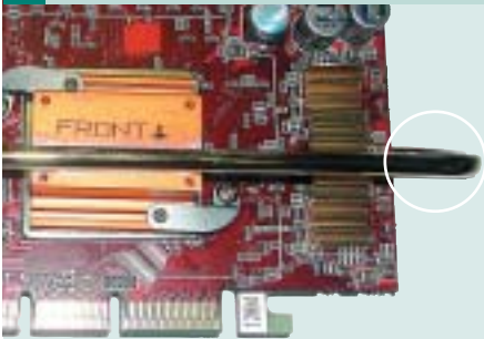
A Heatpipe lógjon le egy-két centiméterrel a kártya jobb széléről
