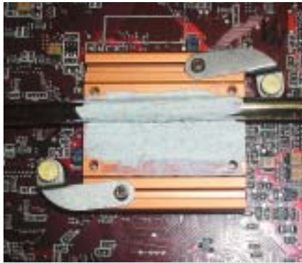
A hátsó oldalon se hanyagoljuk el a szilikonzsír fölkenését, mert e nélkül rosszabb lesz a hővezetés
