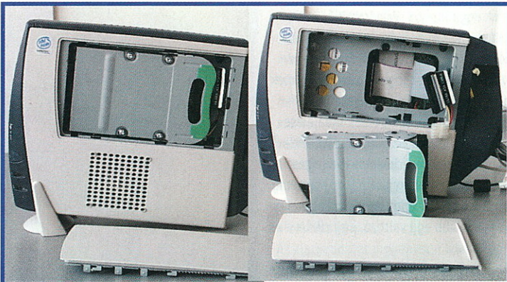
Szerszám nélkül kivethető a merevlemez
